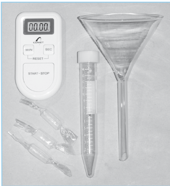
Abb. 17: Einfaches Set zum Bestimmen der Speichelfließrate: Kunststofftrichter, skaliertes Reagenzröhrchen, Paraffinkautablette und Stoppuhr.
